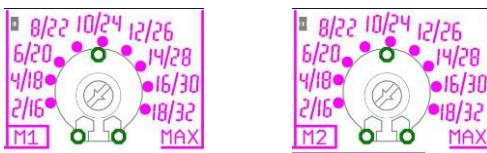
Mediante el trimmer «MAX» es posible ajustar la corriente máxima del motor que, al ser superada, el sistema se colocará en protección por sobrecorriente.
