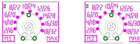
Le trimmer MAX permet de régler la valeur de courant maximum du moteur au-delà de laquelle le système se placera sous protection pour surintensité.
