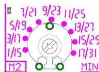
Mediante el trimmer «MIN» se puede regular la corriente mínima del motor para la protección contra el funcionamiento en seco en caso de que se desee una protección adicional o no se deseen utilizar sondas ni flotador de nivel mínimo.
