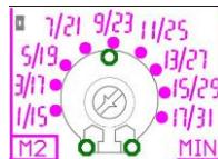
Mediante il trimmer “MIN” è possibile regolare la corrente minima del motore per la protezione contro la marcia a secco nel caso si volesse un ulteriore protezione o non si volessero utilizzare sonde o galleggiante di minimo livello.
