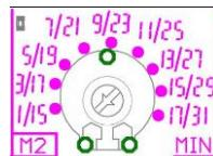
Le trimmer « MIN » permet de régler le courant minimum du moteur en vue d'une protection accrue contre la marche à sec, ou pour ne pas utiliser de sondes ou de flotteurs de niveau minimum.
