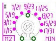
Mit dem Trimmer „MIN“ kann zum Schutz vor Trockenlauf der Mindeststrom des Motors eingestellt werden, falls ein zusätzlicher Schutz gewünscht ist oder keine Mindestfüllstandssonden oder Mindestfüllstandsschwimmer verwendet werden sollen.
